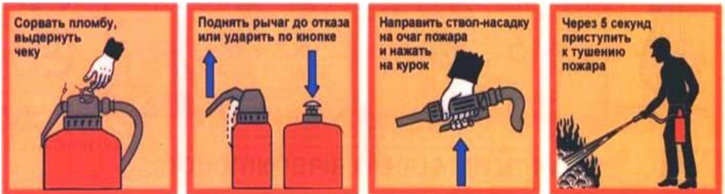
Для закачных огнетушителей эта операция отсутствует, т. к. в них огнетушащее вещество постоянно находится под действием давления сжатого газа или паров огнетушащего вещества (углекислотные огнетушители).
